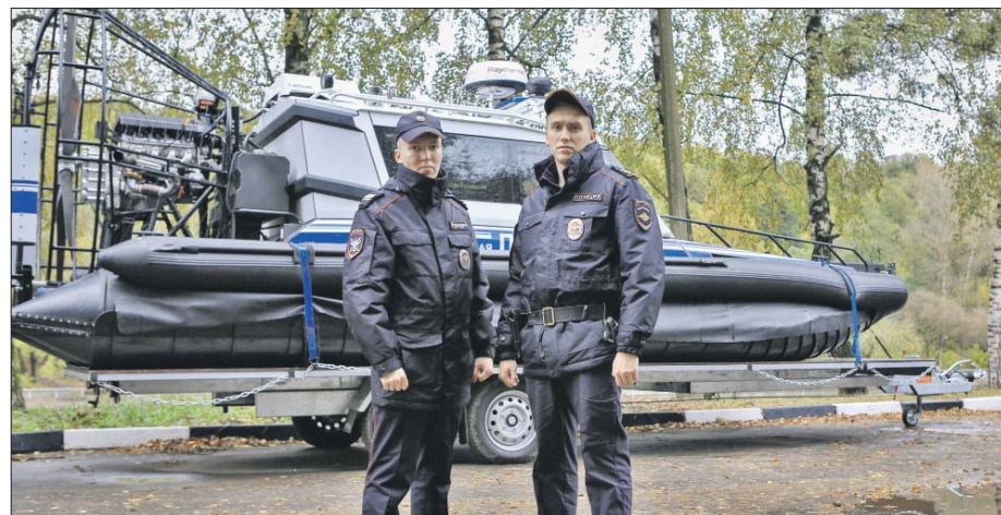
Благодаря воздушной подушке и мощной турбине лодка может ходить по льду и шуге
