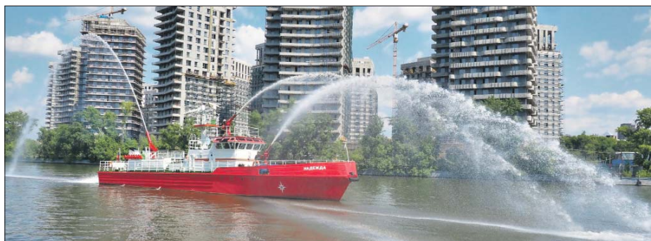
Скорость подачи воды из каждого лафетного ствола — 240 литров в секунду
