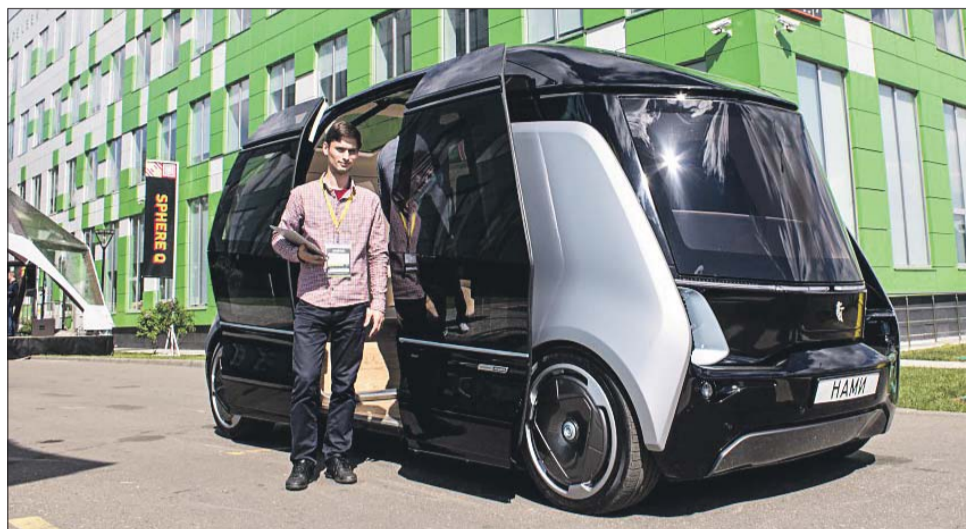
Кузов электробуса изготовлен из композитных материалов, «нанизанных» на стальной каркас
