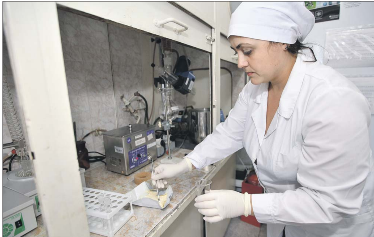
Для анализа кладут небольшой кусочек масла в пробирку и после ряда манипуляций отправляют её в газовый хроматограф
