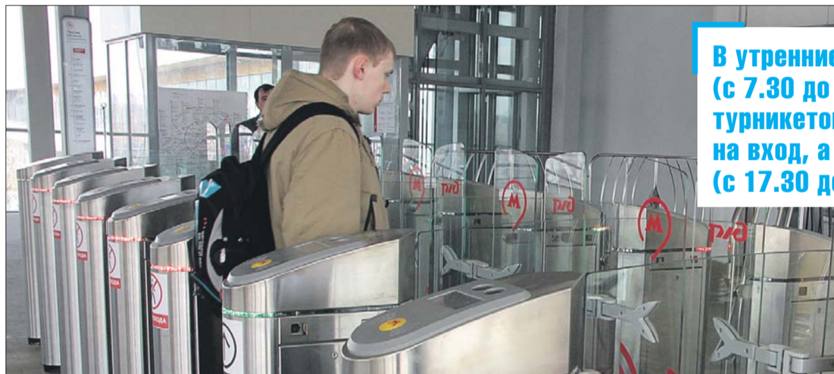
Благодаря реверсивному переключению турникетов среднее время прохода одного пассажира занимает около двух секунд вместо обычных четырёх
